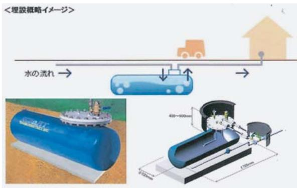
溶接技術を生かして鋼製地下防火水槽を開発した。
