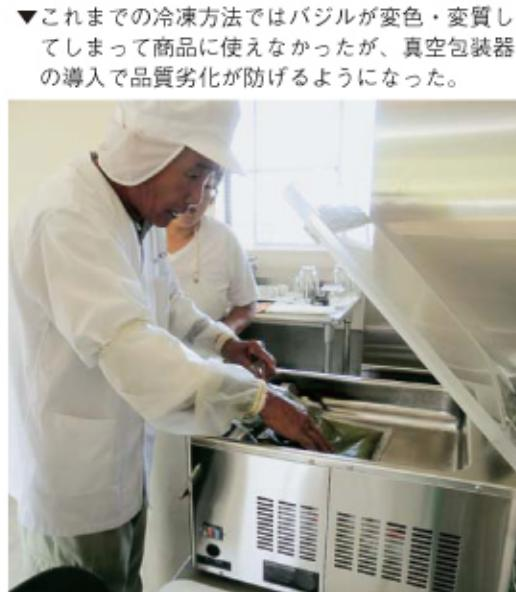
▼これまでの冷凍方法ではバジルが変色・変質してしまって商品に使えなかったが、真空包装器の導入で品質劣化が防げるようにになった。
